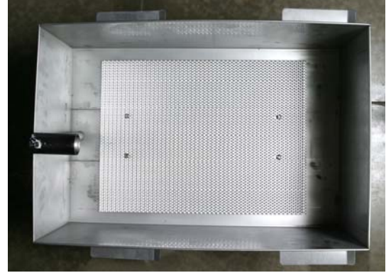
تركيب شبكة الدعم المثبتة داخل وعاء التصفية بصورة ملائمة.
